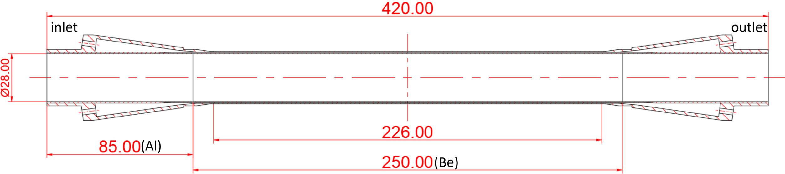
inner Be:  $T=0.50\text{mm}$   $L=420\text{mm}$   $D(\text{inner})=\text{Ø}28\text{mm}$
