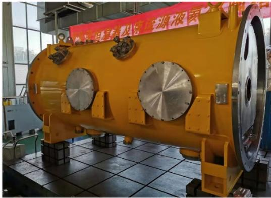
A 650MHz test cryomodule
