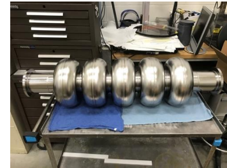
952.6 MHz cooler ERL (SCRF)
